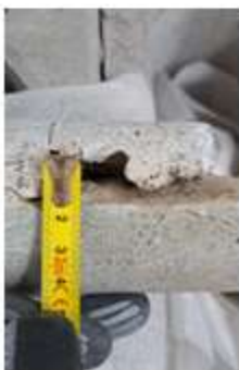
Obr. 3 V hloubce 250 mm byla kaverna o šířce až 20 mm (spojení materiálů)
