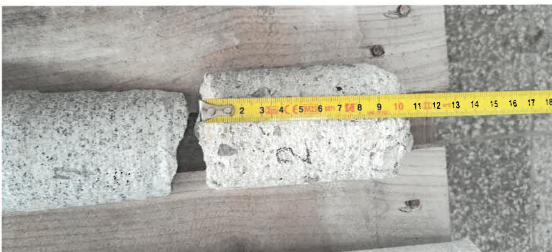
Obr. 5 Části vývrtu 2 (kámen, nezkoušeno, v hloubce beton)
