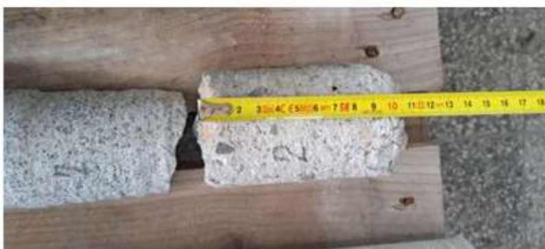
Obr. 5 Části vývrtu 2 (kámen, nezkoušeno, v hloubce beton)
